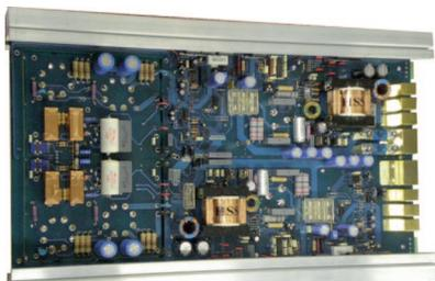
Layout interno con spessore delle piste 105 u, con visibili le sezioni dello stadio di alimentazione completamente separate per i due canali e la circuizione Dual Mono per lo stadio finale di potenza.
